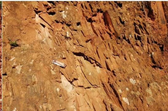
Foto 4. Aspecto de la fracturación del macizo rocoso que favorece la circulación del agua
